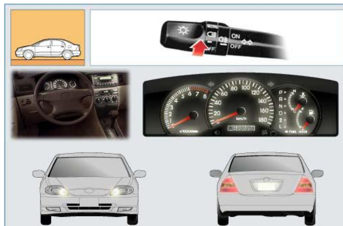
Hình 15.2: Công tắc điều khiển đèn, đèn kích thước và đèn soi bảng số
