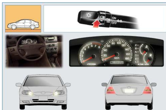
Hình 16.2: Công tắc điều khiển đèn, đèn kích thước và đèn soi bảng số
