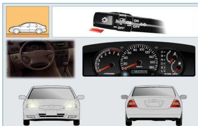
Hình 17.1: Đèn xi-nhan phải công tắc điều khiển đèn và đèn báo trên táp-lô.
