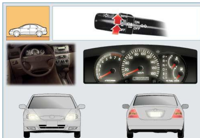
Hình 15.4: Công tắc điều khiển đèn, đèn đầu, đèn soi bảng số.
