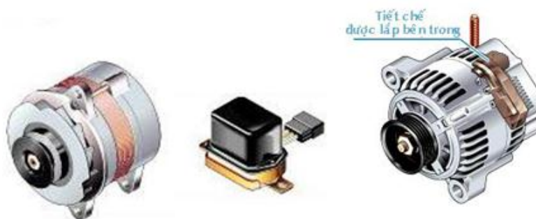
Hình 4.3: Tiết chế đặt bên ngoài, và tiết chế đặt bên trong máy phát.
