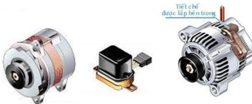
Hình 6.3: Tiết chế đặt bên ngoài, và tiết chế đặt bên trong máy phát.
