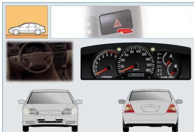
Hình 17.3: Đèn khẩn cấp (Hazard) và đèn báo trên táp-lô
