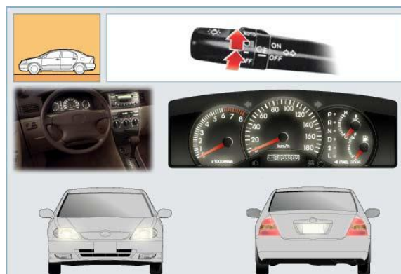
Hình 16.4: Công tắc điều khiển đèn, đèn đầu, đèn soi bảng số.
