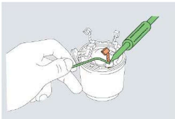
Hình 10.29: Hàn chổi than mới vào vùng gấn.
