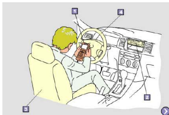
Hình 2.19: Ghi lại những thông tin của xe trước khi tháo cáp ắc – quy.
